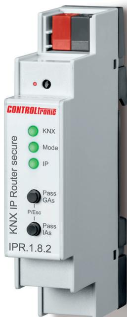
Der kompakte KNX IP Router ermöglicht die Weiterleitung von Telegrammen zwischen verschiedenen Linien über ein LAN (IP) als schnellen Backbone. Das Gerät dient zudem als Schnittstelle zur Anbindung eines PCs oder Smart Devices an den KNX-Bus und kann als Programmierschnittstelle für die ETS verwendet werden.
